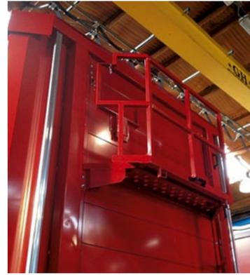
**Das Rollverdeck lässt sich von der Arbeitsbühne an der Stirnseite einfach und schnell bedienen.**
