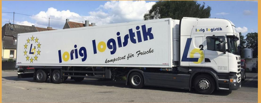
Lorig Logistik setzt bei den zwei neuen Kühlaufliegern S.KO 20/LZG 45 COOL von Schmitz Cargobull auf drei getrennte Temperaturbereiche und das Telematik-System TrailerConnect.
