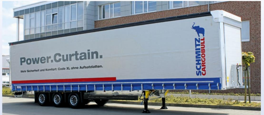
Beim S.CS mit POWER CURTAIN wird die zertifizierte Aufbaufestigkeit nach DIN EN 12642 Code XL durch Aramid-Gurte und in die Plane integrierte Stahldrähte erreicht.
